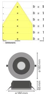
Technische Daten Ledvance LED Downlight Performance DN155 14W 1600lm 65D - 840 Kaltweiß | 180mm - IP54 - Dali Dimmbar
